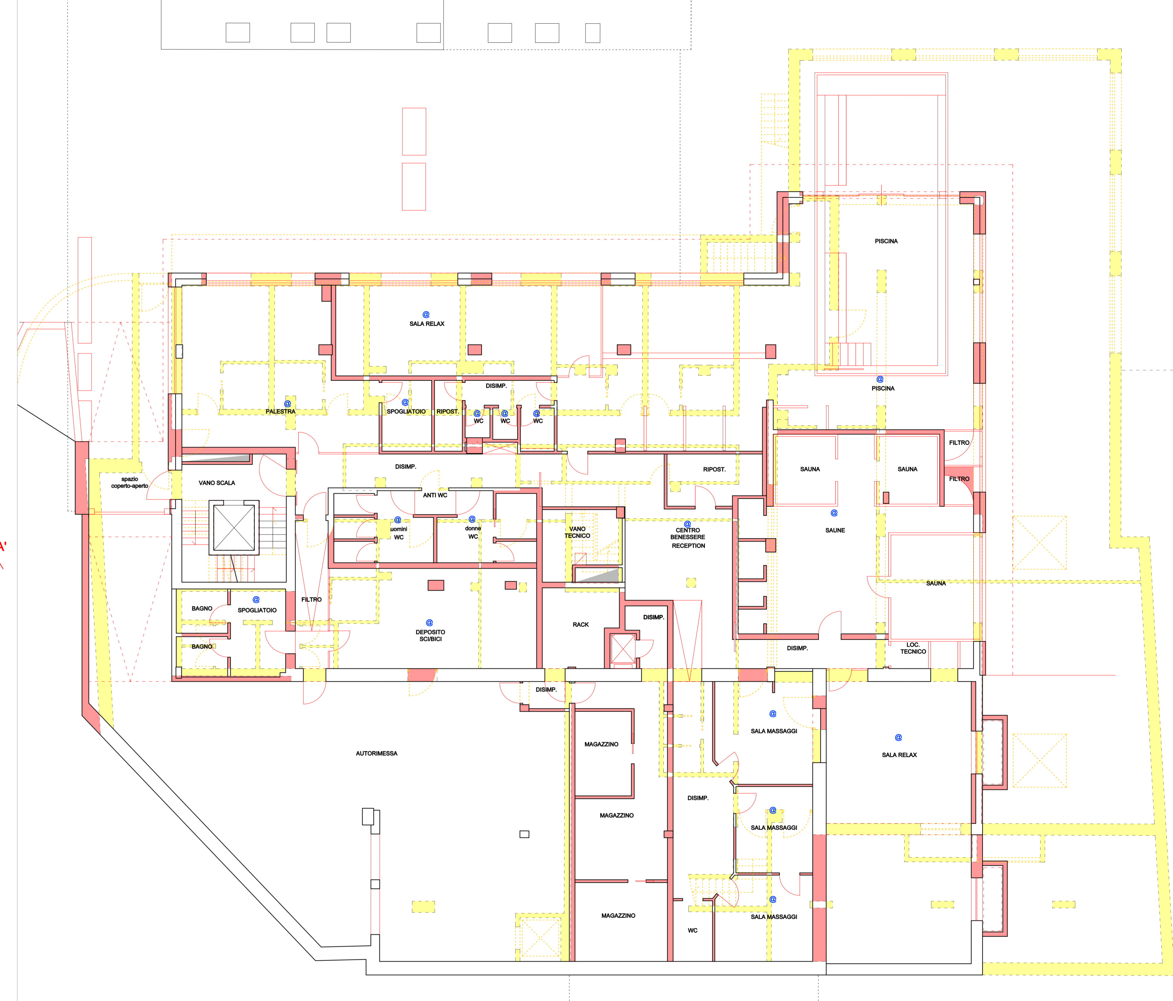
PIANTA PIANO PRIMO INTERRATO - COMPARAZIONE Scala 1:100
